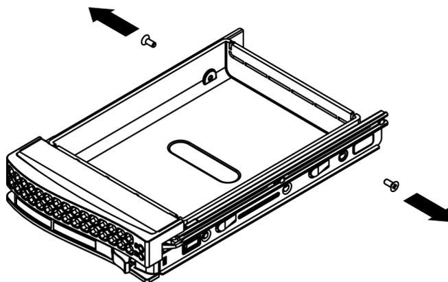
2. Retire la unidad ficticia del soporte de disco duro y coloque el soporte de disco duro sobre una superficie plana.
