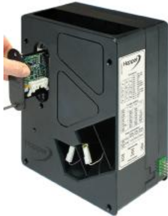
Figura 4: eliminación de PCB
