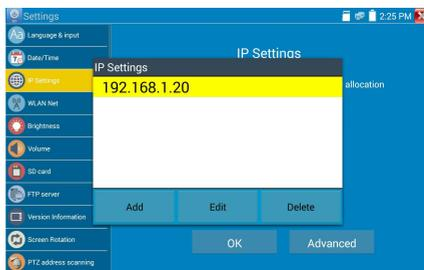
Después de configurar una dirección IP avanzada (consulte las fotos de arriba), la unidad puede probar dos segmentos de red (192.168.5.0) y (192.168.1.0).
