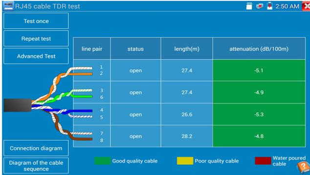
**Prueba única:**pruebe el estado, la longitud y la atenuación del cable.
