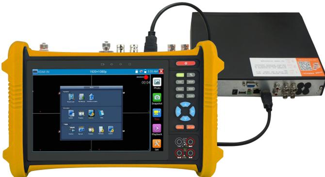
El puerto de entrada HDMI del DVR u otro dispositivo se conecta al puerto de entrada HDMI del probador, el medidor mostrará la entrada imagen.
