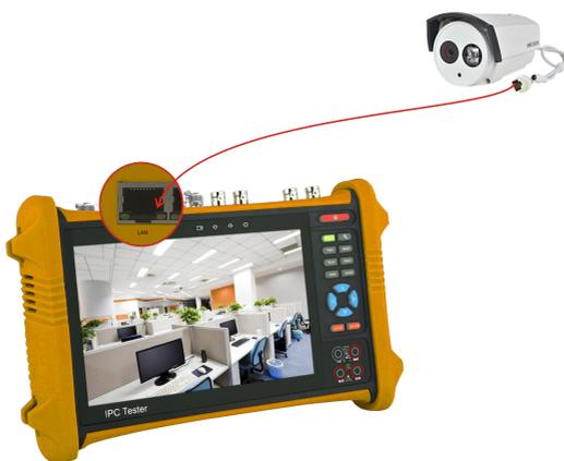
**Nota:1)** Si la cámara IP requiere alimentación PoE, conecte la cámara IP al puerto LAN del probador. Los probadores suministrarán PoE Power para la cámara IP. Haga clic en el icono con la etiqueta POE para activar PoE Power.
