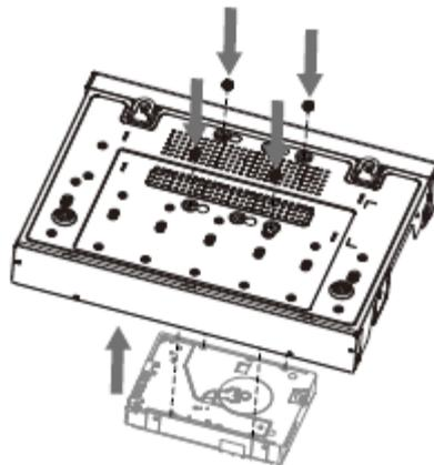
**Paso 4** Conecte el disco duro al dispositivo mediante el cable de datos y el cable de alimentación.
