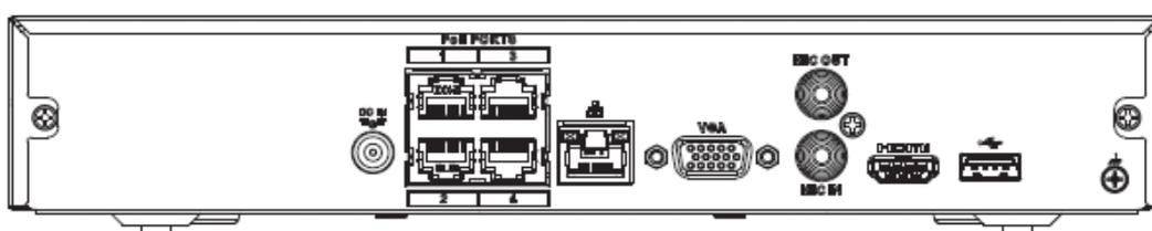
El panel trasero de la serie NVR11HS-8P-S3H/NVR21HS-8P-4KS2/NVR41HS-8P-4KS2/NVR41HS-8P-4KS2/L/NVR41HS-8P-4KS2/H/NVR21HS-8P-S3 se muestra a continuación.
