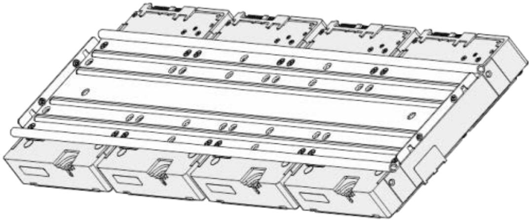
**Paso 6** Bloquee los dos soportes de HDD.
