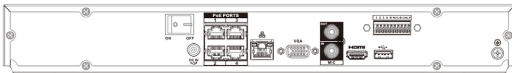
El panel trasero de la serie NVR42-8P-4KS2/NVR42-8P-4KS2/L/NVR42-8P-4KS2/H se muestra a continuación.
