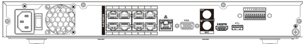
El panel trasero de la serie NVR42-16P-4KS2/NVR42-16P-4KS2/L/NVR42-16P-4KS2/H se muestra a continuación.
