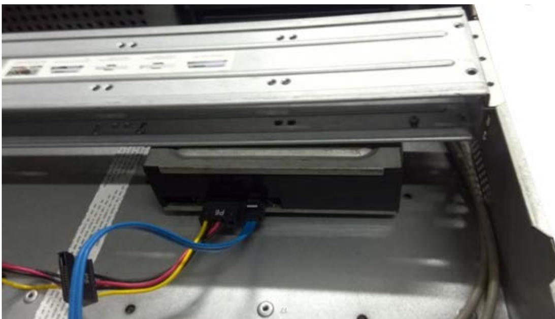
**Paso 9** Asegure el soporte de HDD y vuelva a colocar la cubierta superior.
