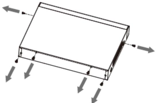
**Paso 2** Quite la cubierta en la dirección de la flecha como se muestra en la siguiente figura.
