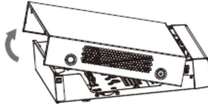
**Paso 3** Voltee el dispositivo y alinee el HDD con los cuatro orificios del panel inferior y luego fije el HDD con tornillos.
