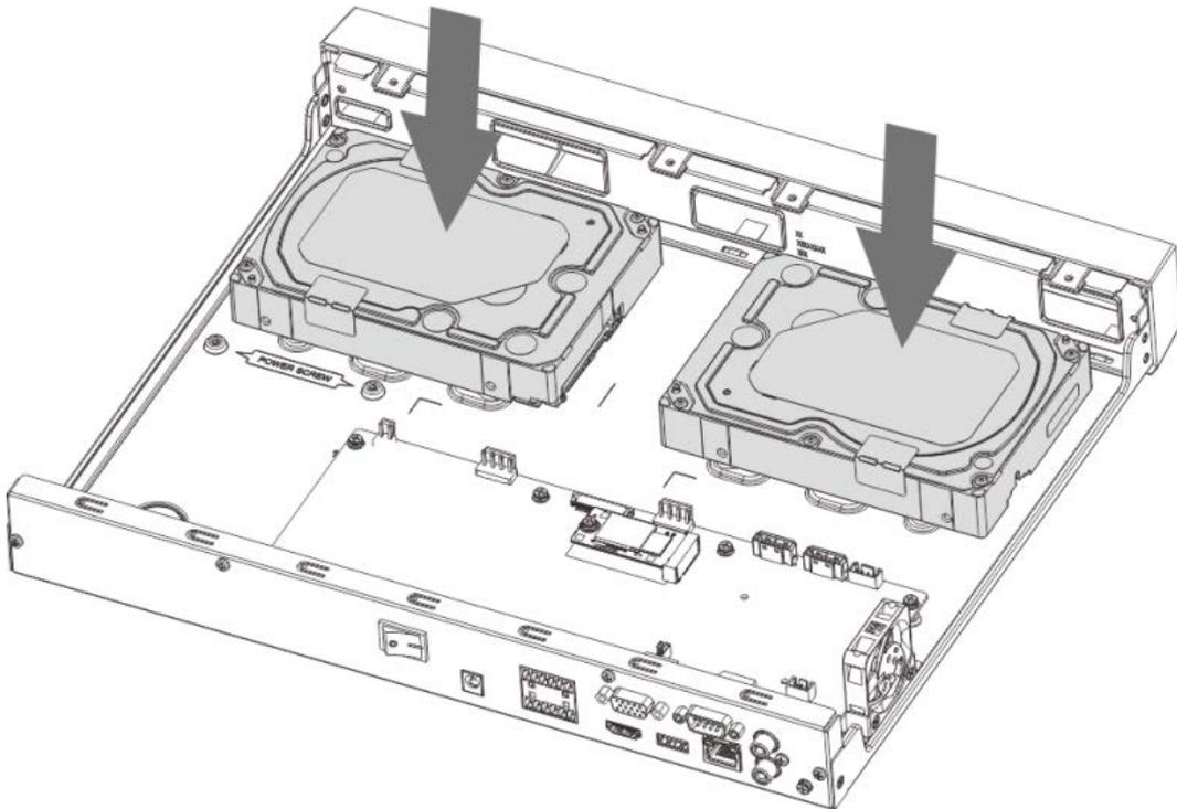
**Paso 4** Voltee el dispositivo boca abajo, haga coincidir los tornillos con los agujeros en el HDD y luego fíjelos. El disco duro está fijado a la placa base.
