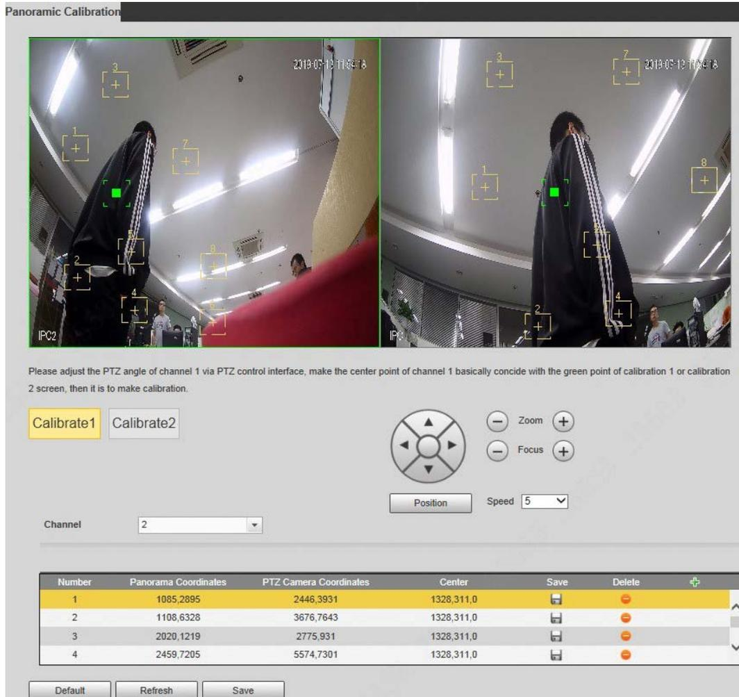
Paso 2 Seleccione el canal 2 y luego seleccione un número de calibración debajo de las imágenes de video por turnos (consulte la Figura 5-21) para agregar puntos de calibración a las imágenes de video correspondientes. Tomar **Calibrar 1** como ejemplo.
