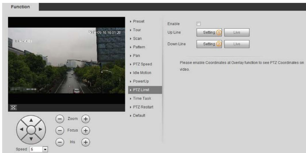
**Paso 2** Ajuste los botones de dirección y luego haga clic en **Ajuste** para configurar la línea ascendente; hacer clic **Ajuste** para establecer la línea descendente.
