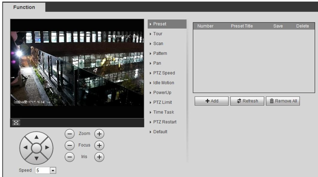
**Paso 2** Establezca la velocidad y haga clic en y para ajustar los parámetros de dirección, zoom, foco e iris, para mover la cámara a la posición que necesites.
