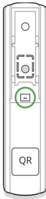
Se recomienda instalar el detector por cable a una distancia máxima de 1 metro: aumentar la longitud del cable incrementará el riesgo de que se dañe y reduzca la calidad de la comunicación entre los detectores.
