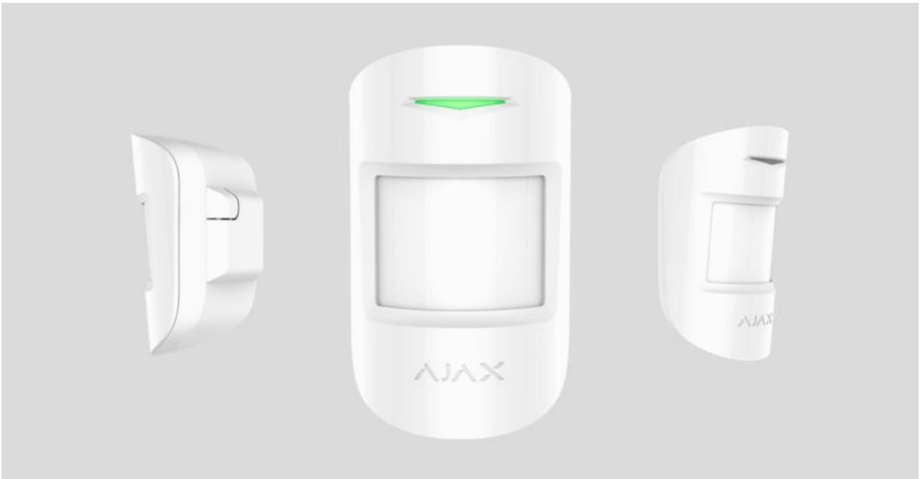
**MotionProtect** es un detector inalámbrico de movimiento diseñado para su uso en interiores. Puede funcionar hasta por 5 años con la batería preinstalada y vigila un área con un radio de 12 metros. Es capaz de ignorar a los animales y, sin embargo, puede reconocer a una persona nada más entre en la zona protegida.
