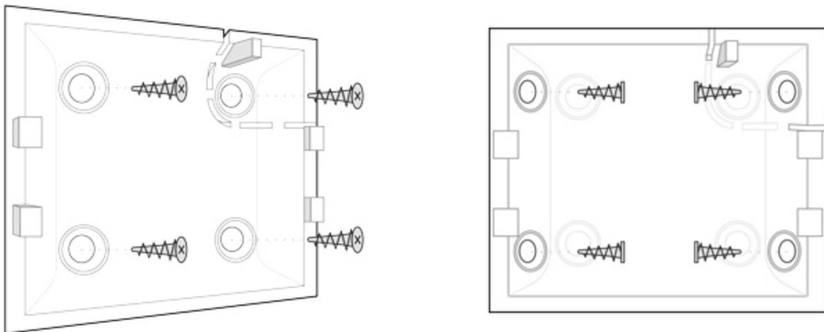
1. Fije el panel SmartBracket a la superficie usando los tornillos incluidos, use al menos dos puntos de sujeción (uno de ellos encima del interruptor antisabotaje). Si usa cualquier otro aditamento de fijación, asegúrese de que no dañe o deforme el panel.
