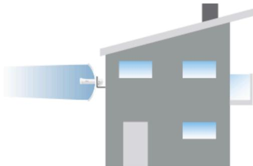
El PowerBeam montado en el exterior sin el reflector instalado proporciona cobertura solamente del exterior al interior a través del bocina de alimentación de 3 dBi.
