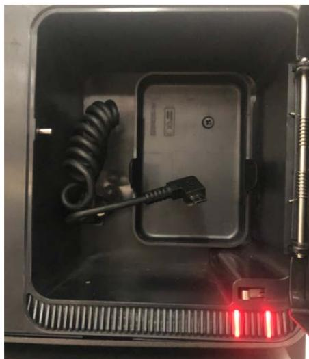
Figura 2-2 Saque el cable de datos (ranura MPT210)
