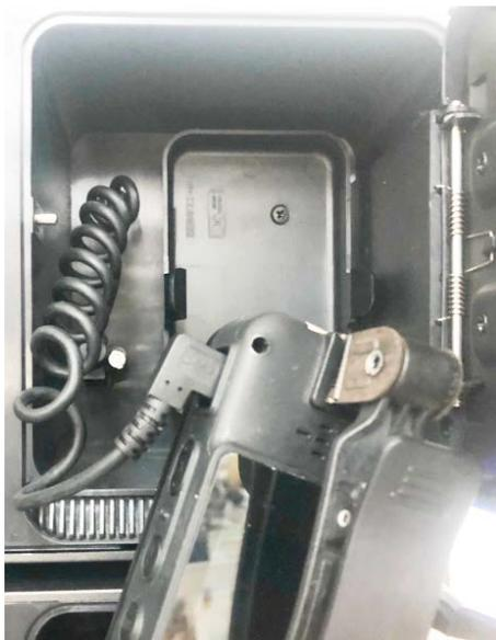
Figura 1-8 Dispositivo de conexión (ranura MPT210)
