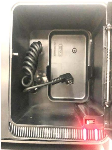
Figura 1-6 Saque el cable de datos (ranura MPT210)
