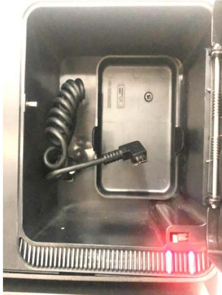
Figure 1-6 Saque el cable de datos (ranura MPT210)
