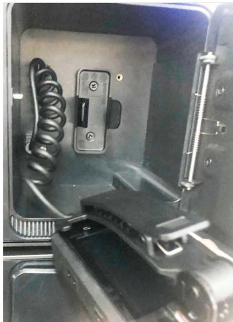
**Step 3** Después de la conexión, coloque la cámara corporal en la base y luego podrá recopilar datos y recargar la cámara corporal.
