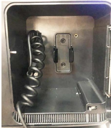
**Step 2** Conecte el cable de datos a la cámara corporal hasta que aparezca el cuadro de diálogo de conexión exitosa de la estación.
