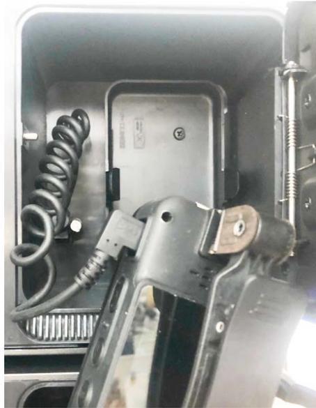
Figure 1-8 Conectar dispositivo (ranura MPT210)
