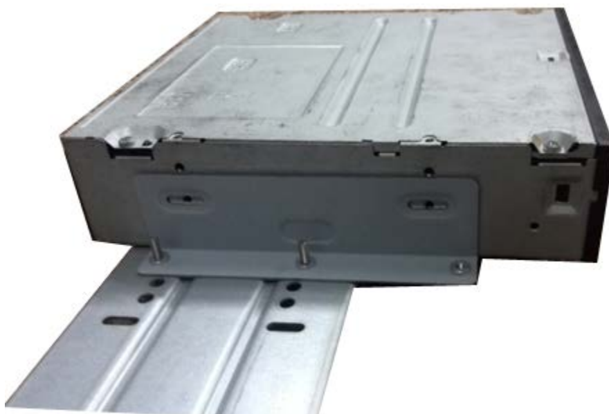
Figura 3-38 Instale la grabadora SATA
