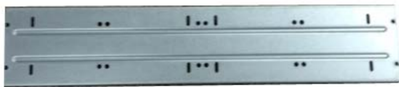
Figura 3-34 Extraiga el soporte del CD-ROM
