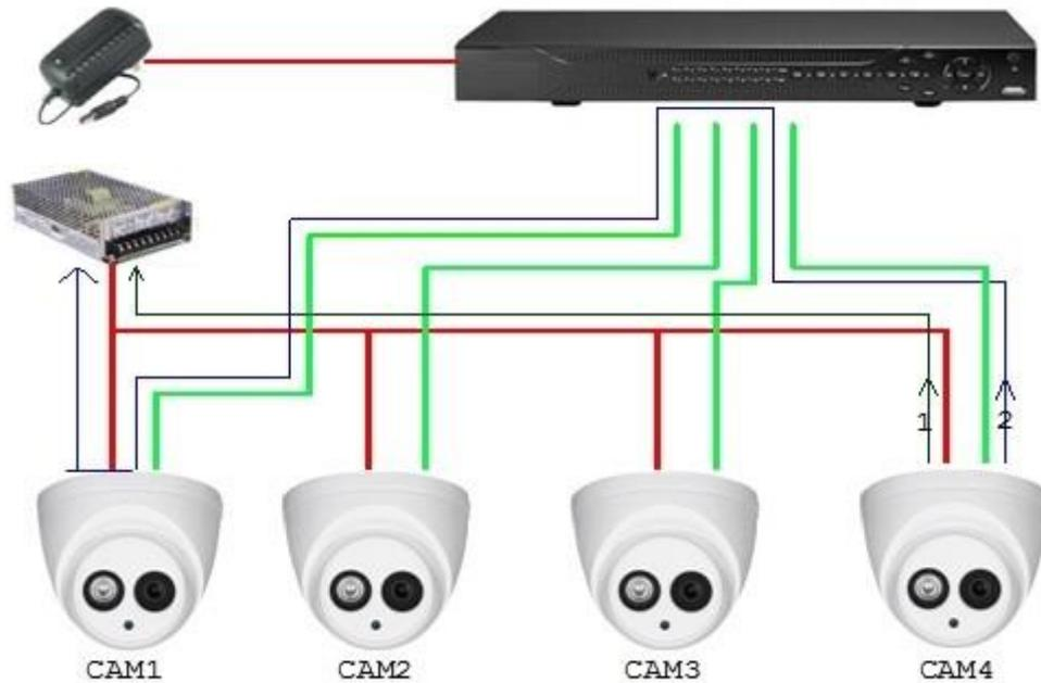
Hay dos rutas para la salida de potencia de CAM4, la ruta de retorno 1 y la ruta de retorno 2. El reflujo 2 fluye primero a CAM1, y luego fluye a la fuente de alimentación desde la tierra de la fuente de alimentación de CAM1. De esta manera, el reflujo de tierra de la fuente de alimentación CAM4 afecta la tierra de video de CAM1, lo que resulta en franjas de interferencia en la pantalla. Y CAM4 también interfiere con CAM2 y CAM3.
