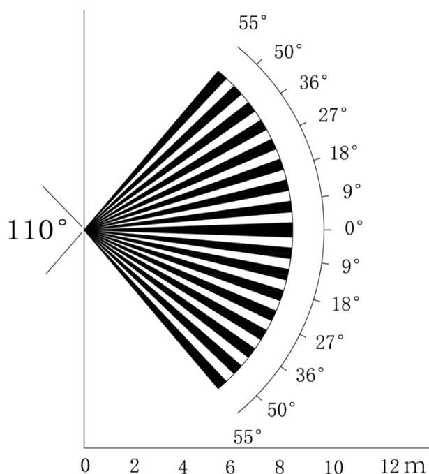
La distancia de detección vertical del sensor es de 2 m - 10 m, 1 m - 14 m o 1 m - 12 m.
