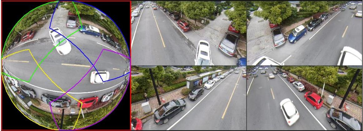
Puede usar el mouse para arrastrar las áreas de color en la pantalla original izquierda o las pantallas rectangulares a la derecha para cambiar los rangos de monitoreo. (No compatible con montaje en pared).
