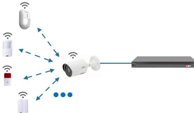
Conecte los dispositivos de nodo inalámbrico a XVR con cámara de puerta de enlace y luego configure los parámetros.
