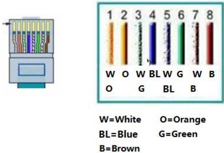
Appendix Figure 8-1 Definición de RJ-45
