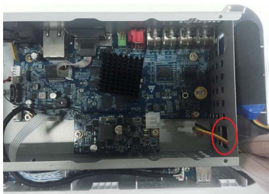
Figure 2-6 Pase el cable de la batería a través del orificio
