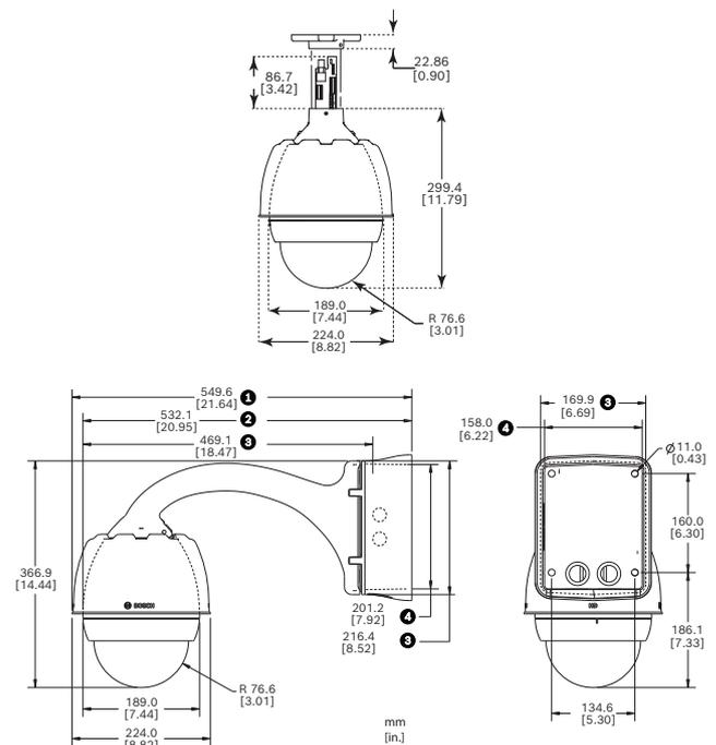
Fig. 1: Dimensiones, montaje de techo AUTODOME 7000, montaje colgante
