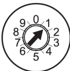
Figura 3.1: Interruptor de dirección configurado en la dirección 1
