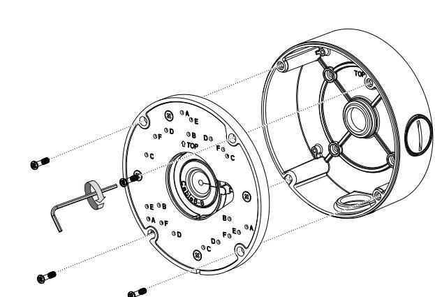
**9** Asegure la cubierta superior fijando los orificios de montaje correspondientes.
