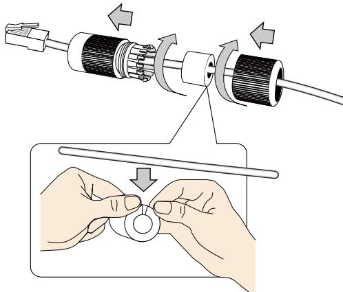
**6** Asegúrese de que el sello de goma esté correctamente instalado en el orificio central. El borde exterior del sello debe atravesar el orificio y cubrirlo.
