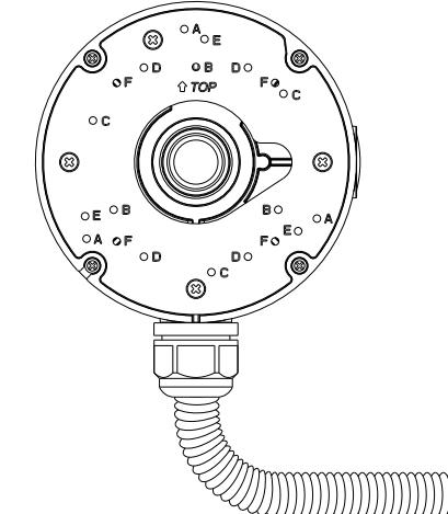
**10** Instale la cámara utilizando los orificios de montaje correspondientes
