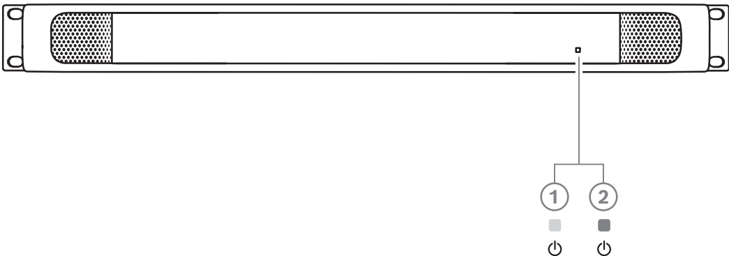
Figura 6.6: Descripción del panel frontal de OMN-DANTEGTW
