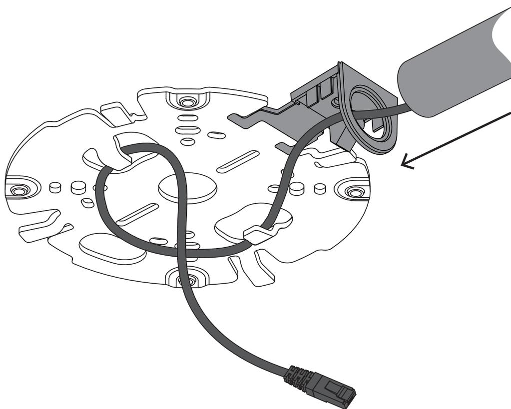
13. Instale la tapa del conducto en la placa para el conducto con el tornillo. Apriete el tornillo a entre 1,4 N·m y 2 N·m.
