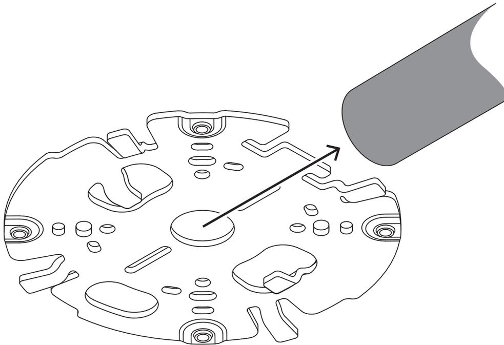
10. Taladre los 4 orificios con el diámetro adecuado para sostener tacos y tornillos de 5-6 mm (0,2 pulg.).
