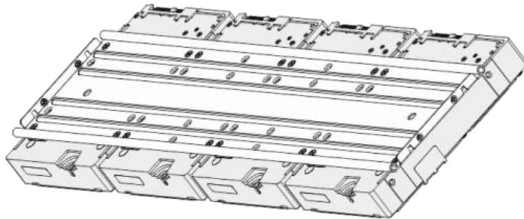
**Paso 6** Coloque el soporte en el dispositivo y luego apriete los tornillos en los lados del soporte.
