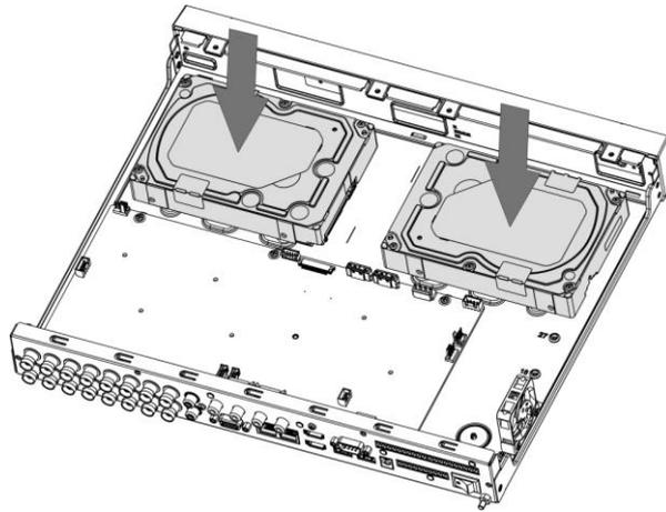
**Paso 4** Gire el dispositivo y coloque los otros dos tornillos, y luego apriete todos los tornillos para fijar el HDD al dispositivo.
