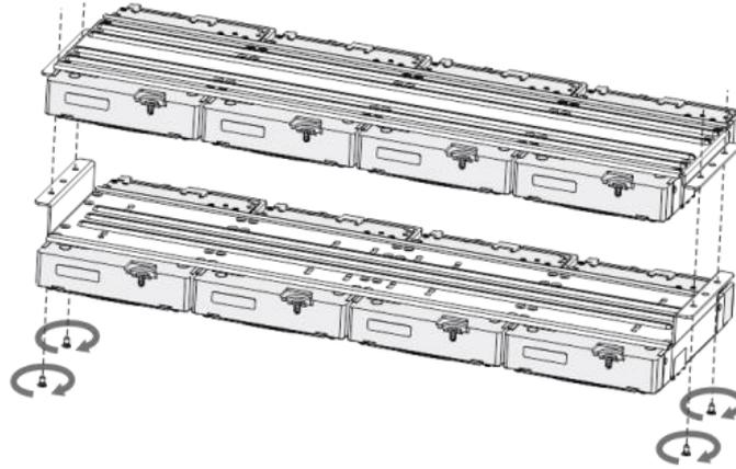
**Paso 7** Vuelva a colocar los soportes de la unidad y fíjelos en el DVR.
