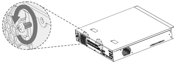
Paso 2 Retire la cubierta en la dirección que se muestra en la siguiente flecha.
