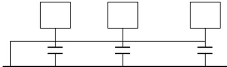
Al conectar dispositivos de gran tamaño (la dimensión física del dispositivo y el cable de conexión son grandes en comparación con la trayectoria de la onda de interferencia existente), existe la posibilidad de interferencia cuando la corriente pasa por el chasis y el cable. En esta situación, la ruta del circuito de interferencia generalmente se encuentra en el circuito de tierra del sistema.
