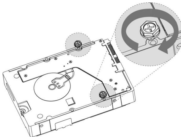
Paso 3 Alinee los dos tornillos con los orificios del dispositivo.
