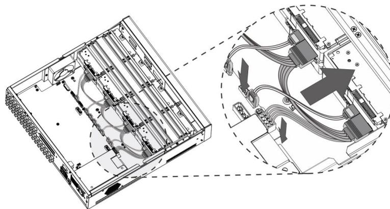
**Paso 9** Vuelva a colocar la tapa y apriete los tornillos.
