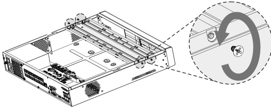
**Paso 4** Haga coincidir los cuatro orificios para tornillos del disco duro con los cuatro orificios del soporte y luego apriete los tornillos. El disco duro está fijado al soporte.
