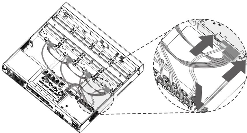
Paso 8 Vuelva a colocar la cubierta y apriete los tornillos en el panel trasero para completar la instalación.
