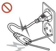
Si el cable de alimentación está conectado a una toma de corriente, no introduzca un palillo ni ningún otro conductor en otra toma de corriente libre. Asimismo, tras desconectar el enchufe de la toma de corriente, no toque las patillas del enchufe inmediatamente.
