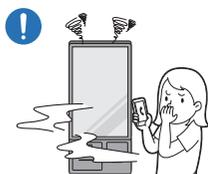
Si el producto genera un ruido extraño, olor a quemado o humo, desconecte de inmediato el cable de alimentación y póngase en contacto con el Centro de servicio al cliente de Samsung.
