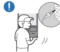
Antes de mover el producto, desconecte el interruptor de alimentación, el cable de alimentación y cualquier otro cable conectado.
