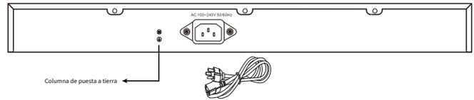
El interruptor ya incluye protección contra rayos. También puede conectarlo a tierra mediante el cable de tierra del cable de CA o con el cable de tierra.
