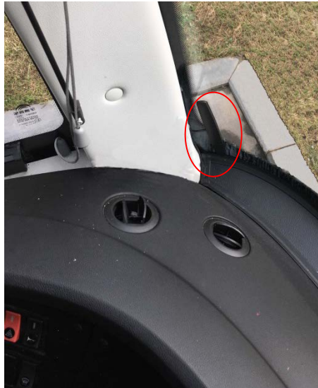
Figure 2-18 Instalación interior de antena de red móvil.
