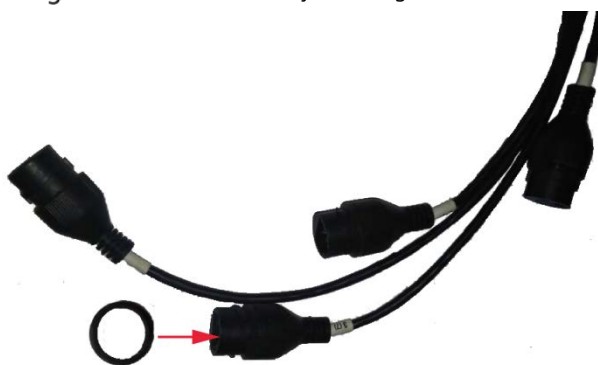
Figure 2-28 Instalación de juntas de goma.
