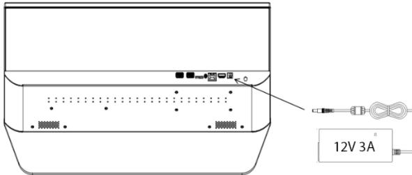
**Paso 3:** Conecte los cables de interfaz y equipos correspondientes según el entorno del usuario.
