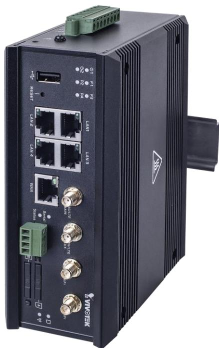
El enrutador LTE PoE-PSE para vehículos AN-P01 de grado industrial ofrece la funcionalidad de un concentrador de conectividad para la adquisición y el procesamiento de datos en tiempo real, un control centralizado de la red y actúa como un equipo de suministro de energía para alimentar dispositivos PoE en campo. Simplifica la implementación de dispositivos PoE, permitiendo la alimentación y la transferencia de datos simultáneas a través de un solo cable Ethernet.
