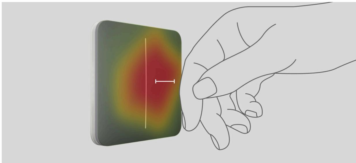
El LightSwitch permite controlar la iluminación al acercar una mano a una distancia de 15 milímetros del interruptor o al tocar el panel táctil del
