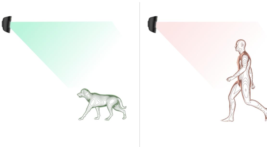
El detector debe instalarse **a una altura de 2,4 metros** sin ninguna obstrucción en su área de detección, por ejemplo, en la esquina de la habitación, donde no se bloqueará su visión con armarios, muebles u otros obstáculos.
