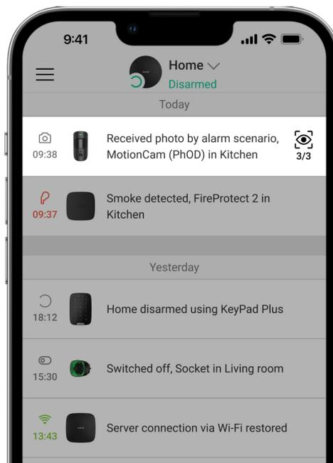
La función Foto por escenario permite crear un escenario para detectores de movimiento con verificación fotográfica, de forma que se tomarán fotografías en respuesta a una alarma en otros dispositivos Ajax.
