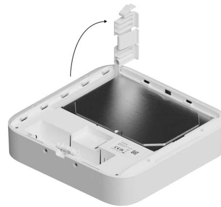
**4.** Instale el disco duro en la carcasa del NVR de manera que las entradas coincidan.
