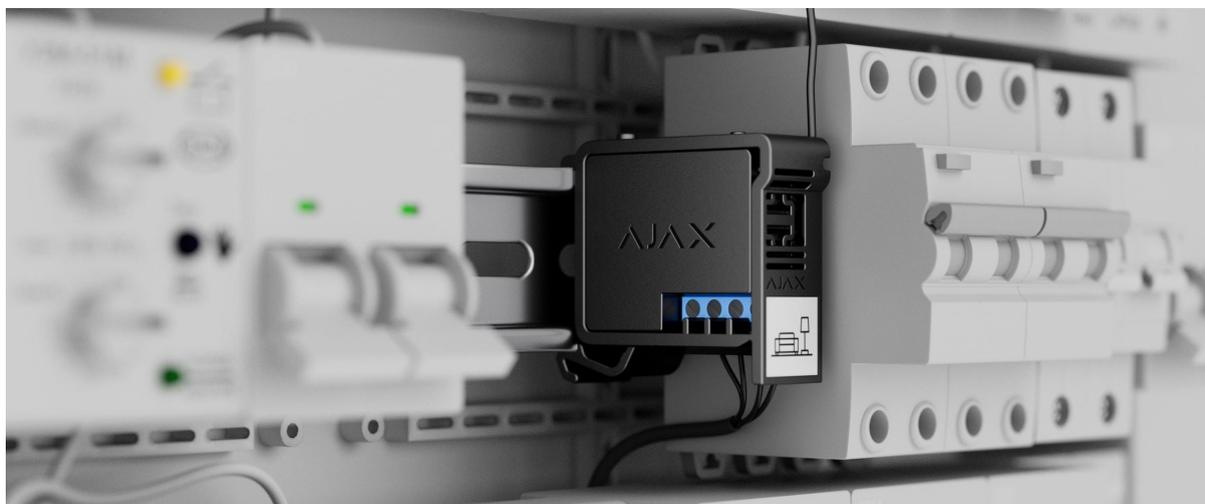
El dispositivo se conecta a la red de 110/230 V~. Las dimensiones del WallSwitch (39 × 33 × 18 mm) permiten instalarlo en una caja de conexiones profunda, dentro de la carcasa de un aparato eléctrico o en un tablero eléctrico. La antena externa flexible garantizará la estabilidad de la comunicación. Para instalar el WallSwitch en un carril DIN, recomendamos utilizar el DIN Holder.
