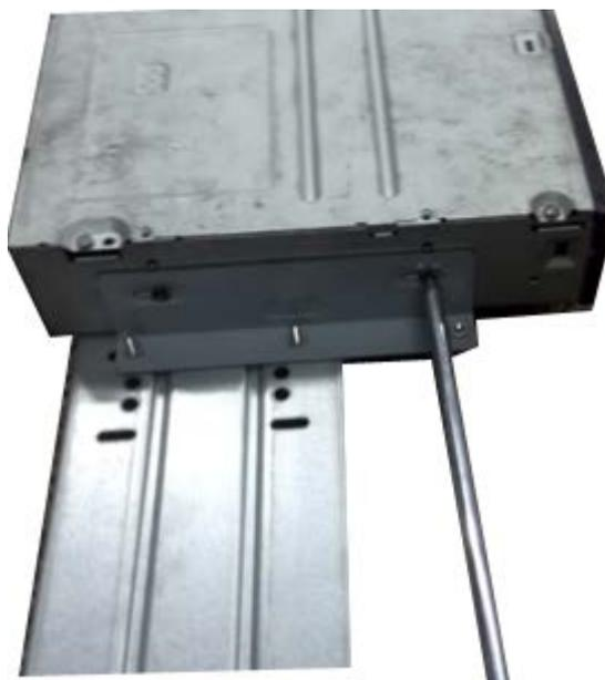
**Paso 7** Vuelva a colocar el soporte. Ajuste el CD-ROM en la posición adecuada de modo que el botón del panel frontal quede directamente frente al botón emergente del CD-ROM.
