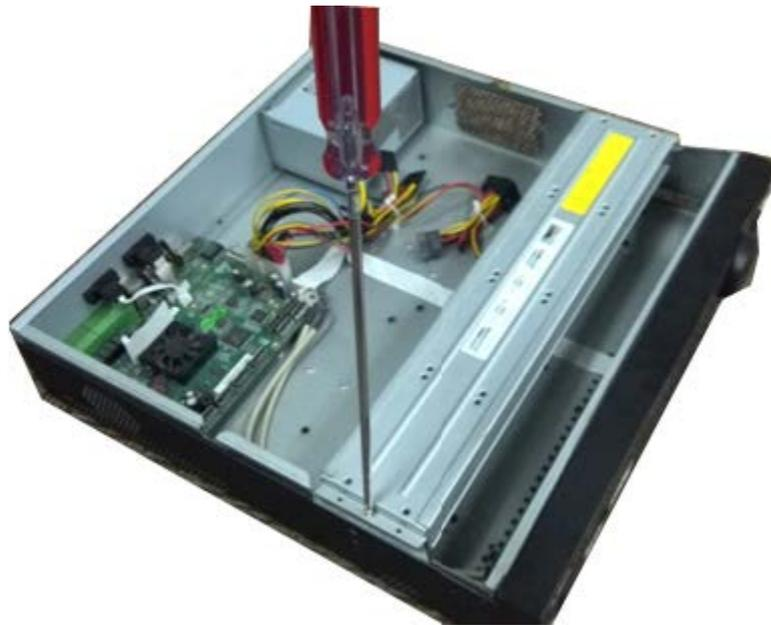
Paso 2 Retire la parte inferior del soporte del disco duro y del soporte del CD-ROM.
