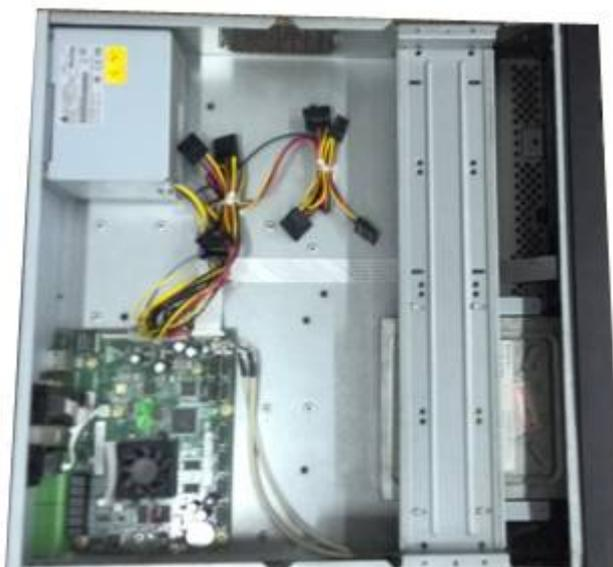
**Paso 8** Conecte el cable SATA y el cable de alimentación.
