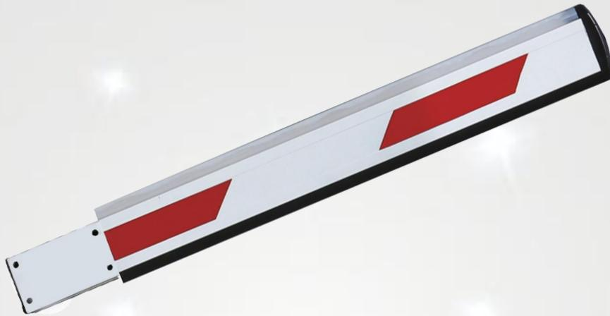
**Descripción:** Brazo recto izquierda LED de 4 metros, diseño rectangular con cubierta de caucho transparente con tira LED y cubierta de caucho negra que sirve para absorción de impacto, cinta reflejantes en color rojo.
