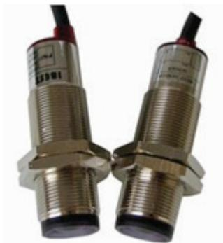
**Interruptor fotoeléctrico reflectante cilíndrico:** ( la función es la misma que la anterior) hay 3 líneas en total, incluidas 2 entradas de alimentación, marrón + 12V, azul: GND y 1 salida de señal (negra). Cuando una persona pasa a través del interruptor fotoeléctrico reflectante (la distancia de reflexión es de 10-20 mm), la salida es de + 12V, de lo contrario es de 0V.
