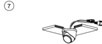
Cable que atraviesa la superficie de montaje
