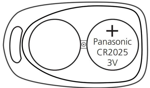
**NOTA:** Debe observarse la polaridad de la batería, como se muestra en el diagrama anterior. El manejo inadecuado de las baterías de litio puede provocar la generación de calor, una explosión o un incendio, lo que puede provocar lesiones personales.
