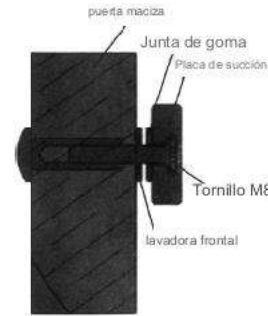
Vista en sección de la estructura de montaje para placa de absorción de hierro de tipo colgante
