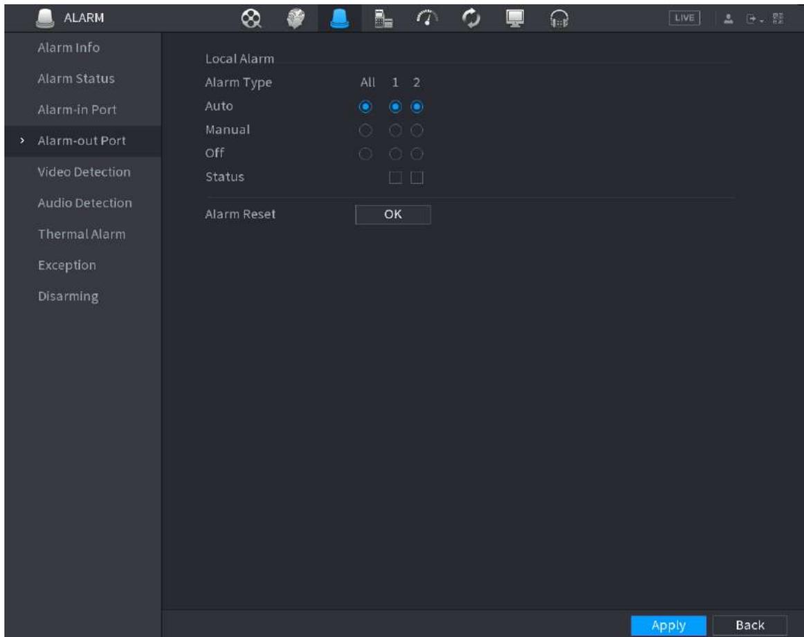
**Paso 2** Seleccione el modo de alarma del canal de salida de alarma. Hacer
