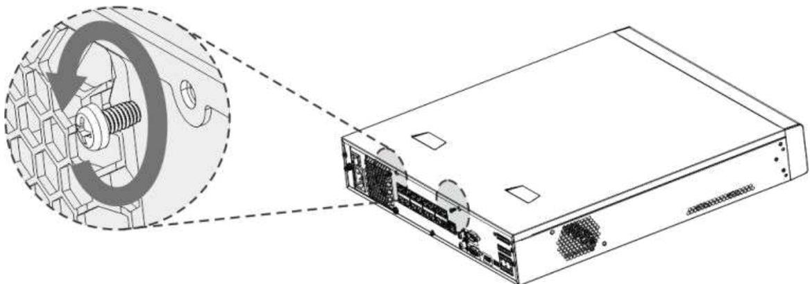
**Paso 2** Retire la cubierta de la caja en la dirección que se muestra en la siguiente flecha.
