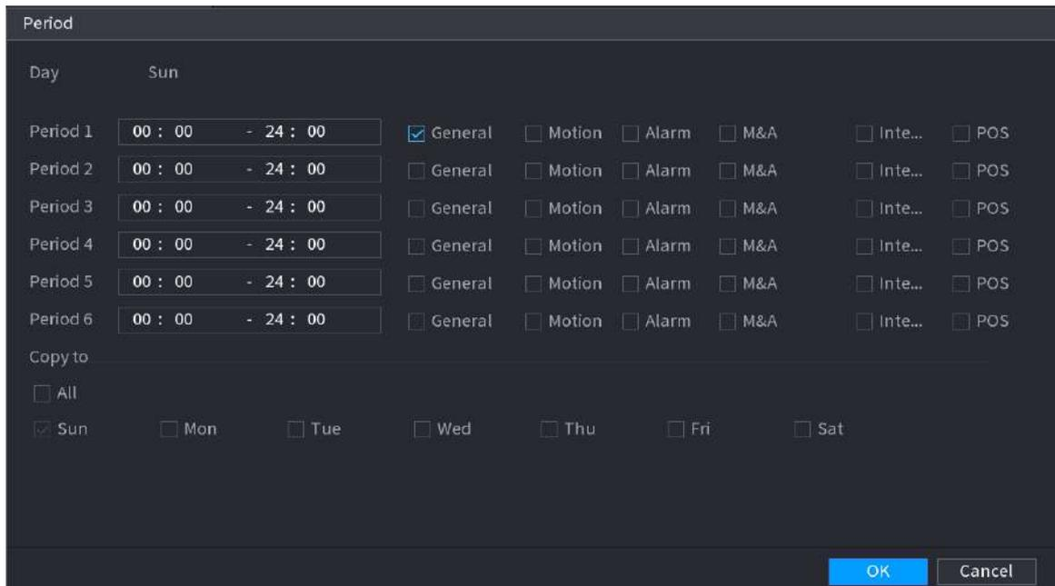
**Paso 3** Configure uno o más tipos de grabación desde **General**, **Movimiento** (detección de movimiento), **Alarma**, **MAMÁ** (detección de movimiento y alarma), **Inteligente** y **punto de venta**.
