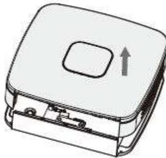
Paso 3 Voltee el dispositivo y luego asegure los tornillos firmemente.
