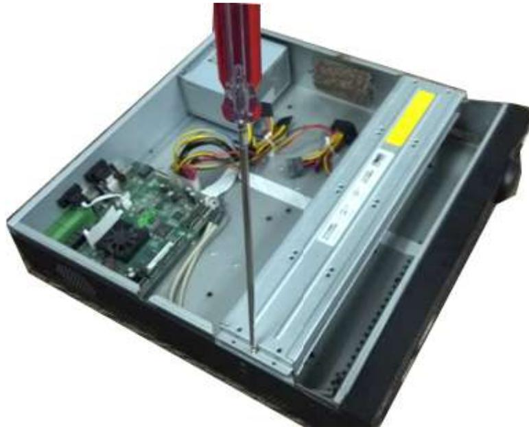
Paso 2 Retire la parte inferior del soporte del HDD y del soporte del CD-ROM.
