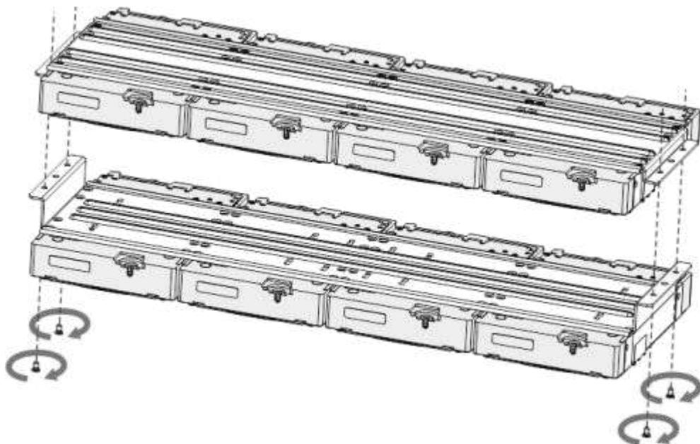
**Paso 7** Coloque el soporte en el dispositivo y luego ajuste los tornillos a los lados del soporte.
