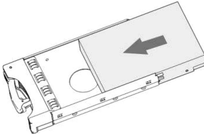
**Paso 3** Apriete los tornillos a los lados de la caja del disco duro.
