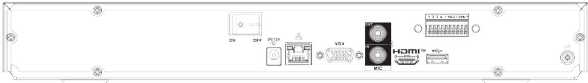
El panel trasero de la serie NVR42-P-4KS2/NVR42-P-4KS2/L/NVR42-P-EI/NVR42-P-4KS3 se muestra a continuación.
