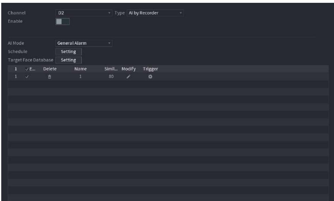
**Paso 3** Hacer clic **Configuración** junto a **Cronograma** para configurar los períodos de armado. Las acciones de alarma correspondientes están vinculadas por los eventos de alarma activados durante el período armado.
