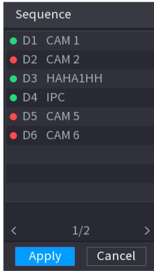
Paso 2 Sobre el **Secuencia** panel, arrastre el canal a la ventana deseada o arrastre en la ventana en vivo para cambiar la posición.
