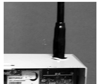
TL260 - funda de cable de montaje Antena de extensión conectada
