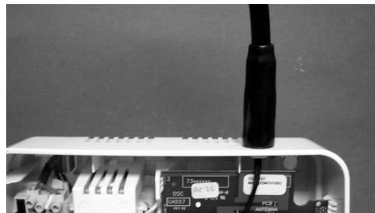
Antena de extensión conectada al TL265GS / GS2065
