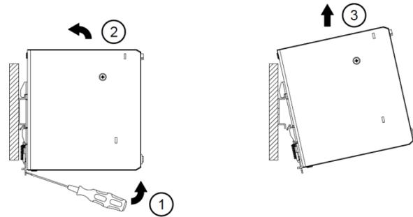
**Fig. 2.2 Desmontaje**
