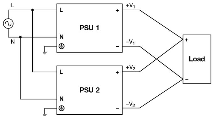
Figura 4 Diagrama de conexión de operación en paralelo
